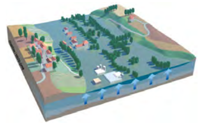
Figure 9. Inondation par remontée de nappe (DDRM 62)
